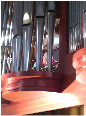
Blick durch die Prospekt-pfeifen (hier der Prinzipal 8') in das Hauptwerk.
